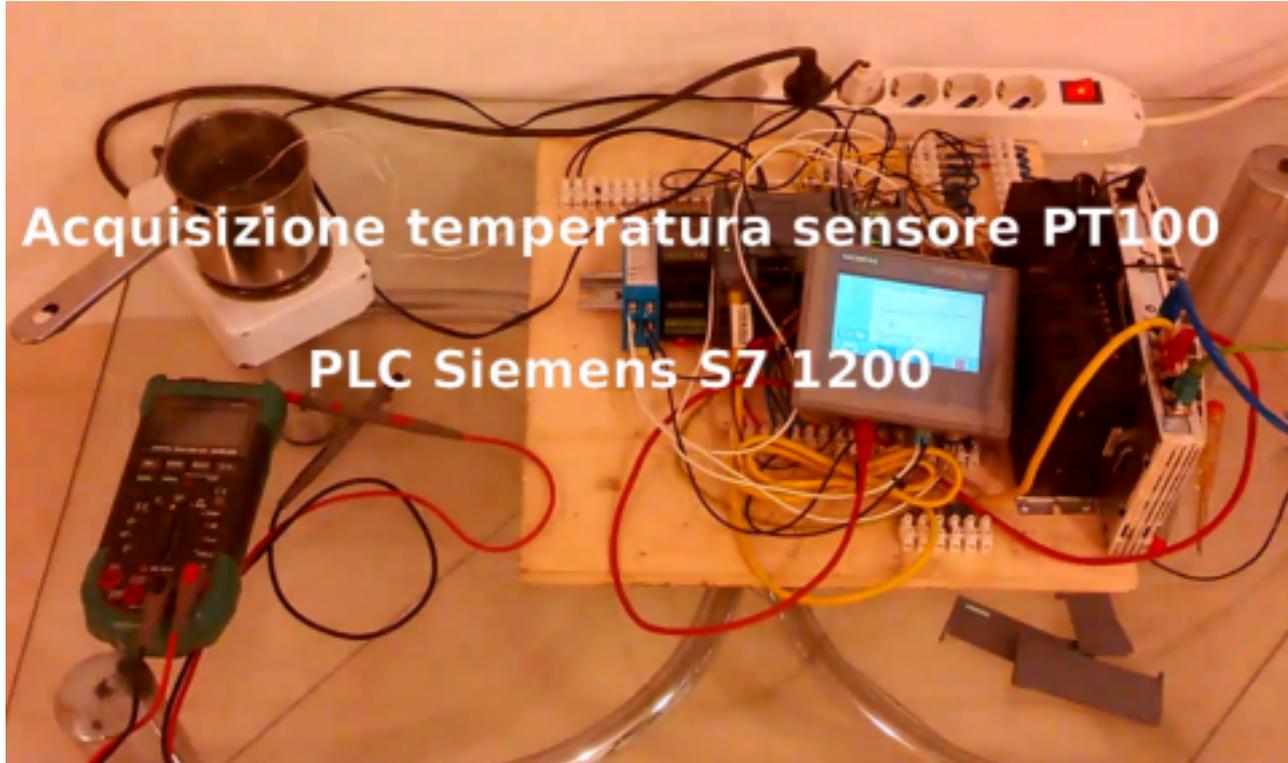
Sistema di acquisizione di temperatura basato su sensore PT100 con amplificatore di trasduzione segnale.
