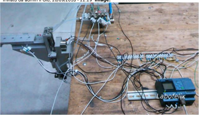
Sistema pneumatico di traslazione lineare a due gradi di libertà Valvole pneumetiche 5/2 su centralina di innesto Logica di controllo basata su Siemens LOGO Cilindri pneumatici a doppio effetto con finecorsa a rivelazione magnetica
